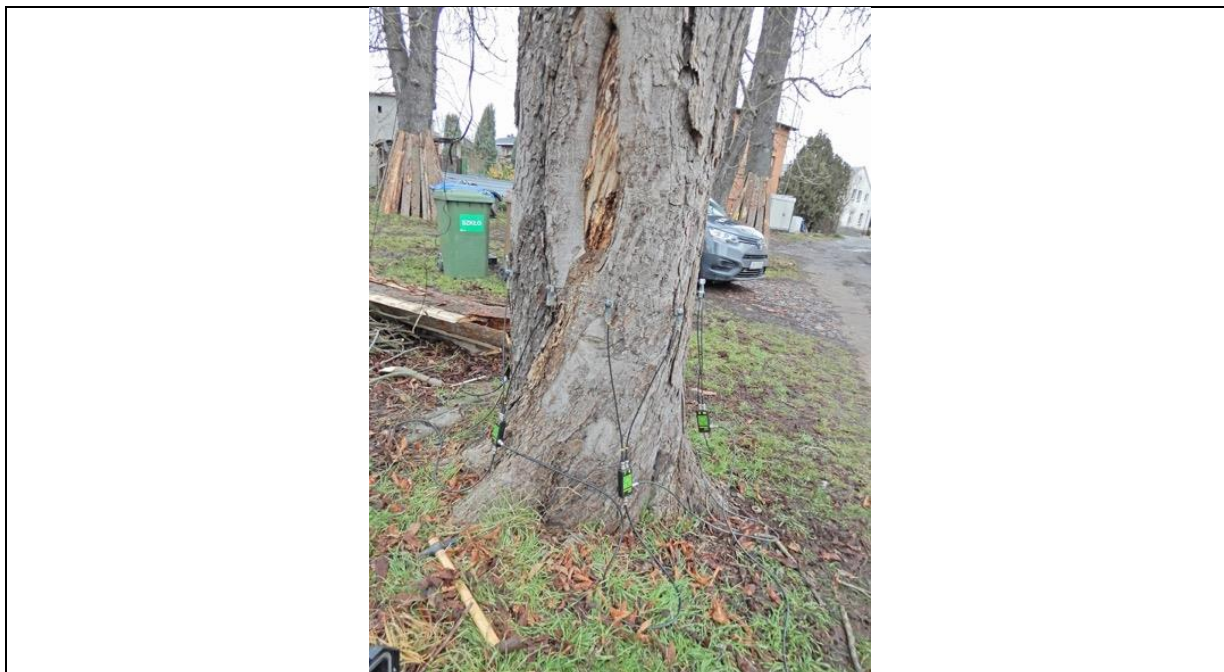
Fot. 4.9. Kasztanowiec biały nr 4, Ratowice przy posesji nr 50. W trakcie badania tomografem sonicznym na wys.30cm.
