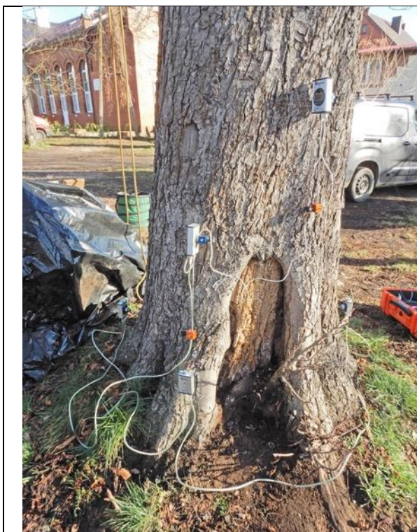
Fot. 1.11. Kasztanowiec biały nr 1, Ratowice przy posesji nr 50. Próba obciążeniowa - miejsce mocowania czujników - strona rozciągana
