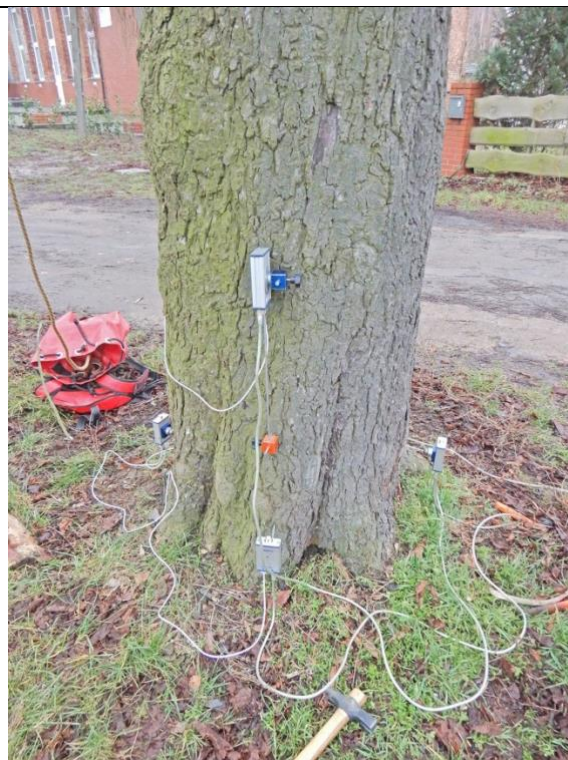
Fot. 3.10. Kasztanowiec biały nr 3, Ratowice przy posesji nr 50. Próba obciążeniowa - miejsce mocowania czujników – strona ściskana
