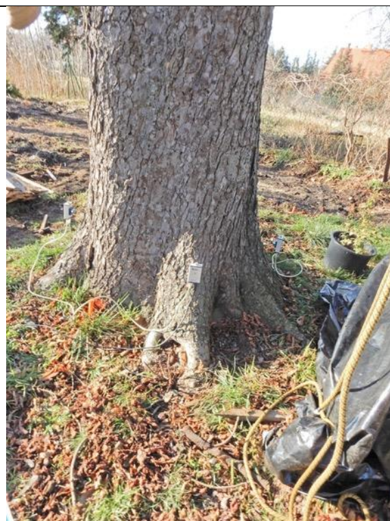
Fot. 1.12. Kasztanowiec biały nr 1, Ratowice przy posesji nr 50. Próba obciążeniowa - miejsce mocowania czujników - strona ściskana
