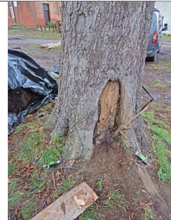
Fot. 1.9. Kasztanowiec biały nr 1, Ratowice przy posesji nr 50. Badanie tomografem na wys. 42 cm – miejsce mocowania czujników.
