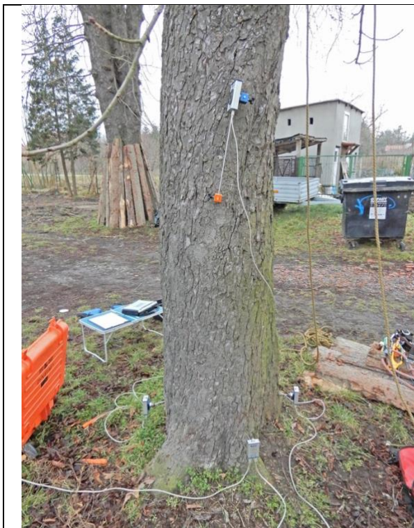
Fot. 3.9. Kasztanowiec biały nr 3, Ratowice przy posesji nr 50. Próba obciążeniowa - miejsce mocowania czujników - strona rozciągana
