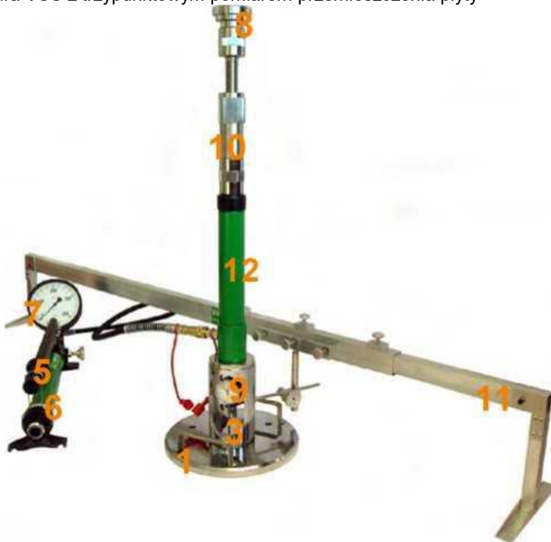
Rys. 1.2 Aparatura VSS z jednopunktowym pomiarem przemieszczenia płyty
